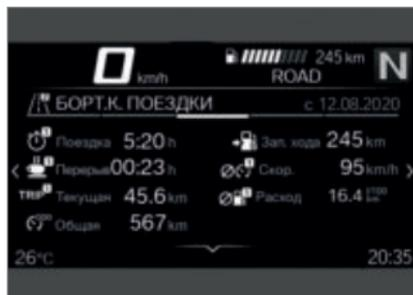
На панели меню **БОРТ. КОМПЬЮТЕР И БОР. КОМП. ПОЕЗДКИ** выводятся данные мотоцикла и поездки, например средние значения.
