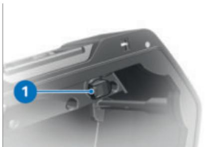
Здесь речь идет о USB-разъеме для зарядки 5 В **1** с максимальным зарядным током 3 А (макс. зарядная мощность 15 Вт).
