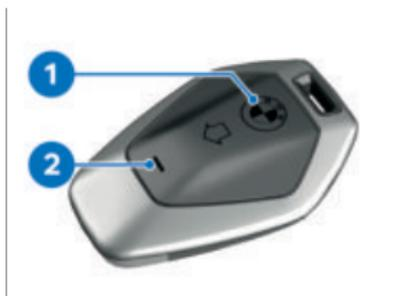
Напряжение батарейки радиоключа показывается цветом светодиода **2**.
