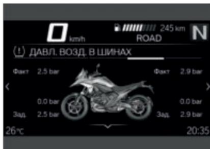
Значения слева относятся к переднему колесу, значения справа – к заднему. Разность давлений отображается в виде заданного и фактического давления в шинах. Сразу после включения зажигания отображаются только черточки. Фактические значения давления в шинах начинают передаваться только после первого превышения следующей минимальной скорости:
