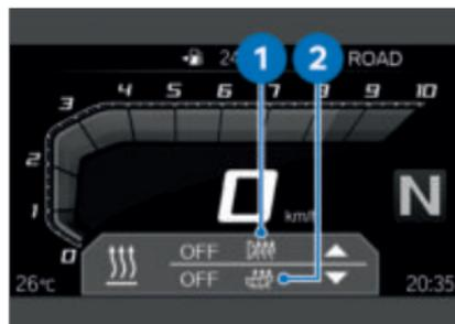
Рукоятки руля **1** и сиденье водителя **2** имеют по три уровня обогрева. Высокая мощность обогрева предназначена для быстрого нагрева, после чего следует переключиться на более низкую ступень.
