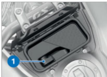
Здесь речь идет о зарядном разъеме USB 5 В **1** с максимальным зарядным током 2,1 А (макс. зарядная мощность 10,5 Вт).
