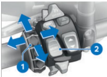
Для управления системой навигации используется мультиконтроллер **1** и двухпозиционная клавиша MENU **2**.
