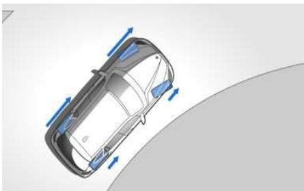
Performance Control с помощью системы управления двигателем и целенаправленного притормаживания воздействует на отдельные колеса. Так как в повороте внешнее колесо проходит больший путь по сравнению с внутренним колесом, система Performance Control в повороте направляет на внешнее колесо больший, а на внутреннее колесо меньший крутящий момент. Это позволяет легче "заправить" автомобиль в поворот. В результате повышается безопасность и динамика движения.
