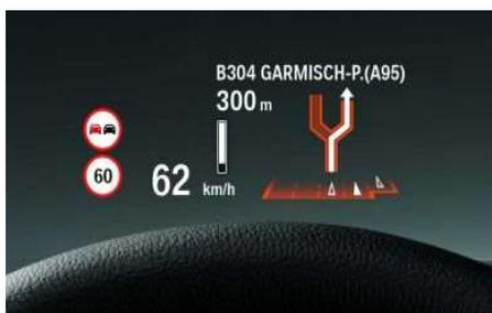
Полноцветный проекционный дисплей BMW выводит важную информацию в поле зрения водителя и повышает тем самым его концентрацию на дорожной ситуации. На проекционном дисплее могут отображаться, в частности, скорость движения, указания навигационной системы, индикатора ограничения скорости и запрета на обгон, а также списки вызовов телефона и данные информационно-развлекательной системы.
