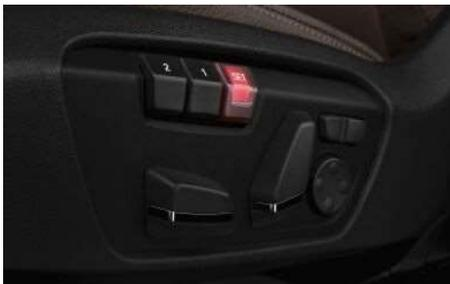
Электрорегулировка сидений упрощает их настройку, а функция памяти позволяет запомнить наиболее удобное положение для сиденья и зеркал заднего вида.
