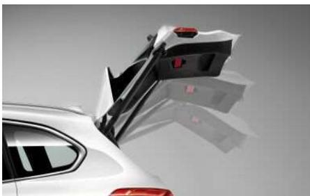
Автоматический привод крышки багажника избавит Вас от необходимости открывать и закрывать его вручную. Достаточно лишь нажать кнопку в салоне или в самом багажнике. Оборудован механизмом мягкого закрывания и системой звукового оповещения.
