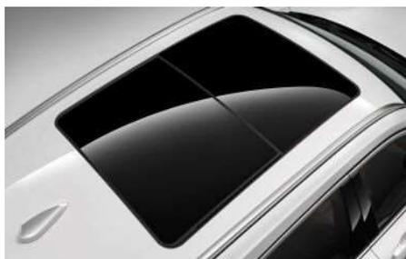
Дополнительный свет, проникающий в салон через такую крышу, делает атмосферу в Вашем автомобиле еще более притягательной. При чрезмерно ярком солнечном свете можно воспользоваться потолочной двойной солнцезащитной шторкой с электроприводом. Интегрированный автоматически выдвигающийся ветроотражатель не только подавляет нежелательные воздушные завихрения, но и повышает степень акустического комфорта при движении с открытой крышей.
