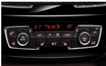
В состав двухзонного климат-контроля входит система контроля загрязненности наружного воздуха (AUC) с фильтром из активированного угля, а также датчик запотевания и солнечный датчик.
