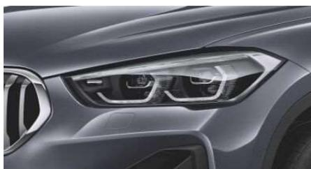
Светодиодные фары дальнего и ближнего света с функцией освещения поворотов отличаются ярким светом, очень близким к дневному.
