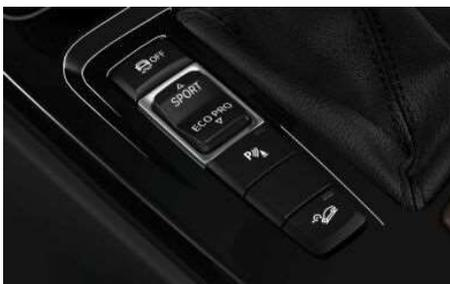
Система позволяет адаптировать настройки амортизаторов к текущим условиям и повысить тем самым комфорт и динамику движения. Наряду со стандартной настройкой COMFORT, которая обеспечивает более высокий уровень комфорта, предлагается режим SPORT. В этом режиме амортизаторы становятся жестче, автомобиль становится "острее" в реакциях и приобретает более спортивные настройки
